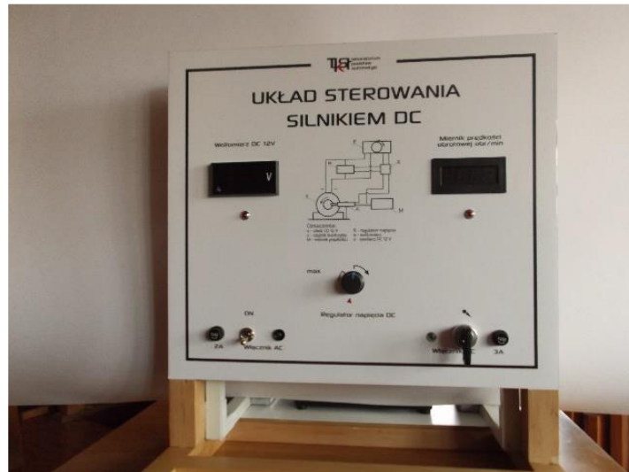
Rys.12. Stanowisko układu sterowania silnikiem elektrycznym DC
