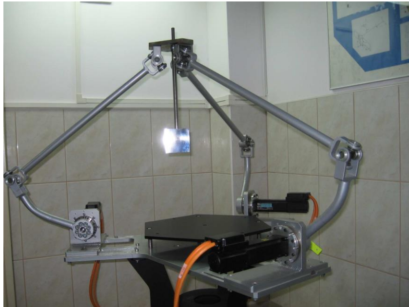
Rys. 5.1. Stanowisko manipulatora bez układu pomiarowego
