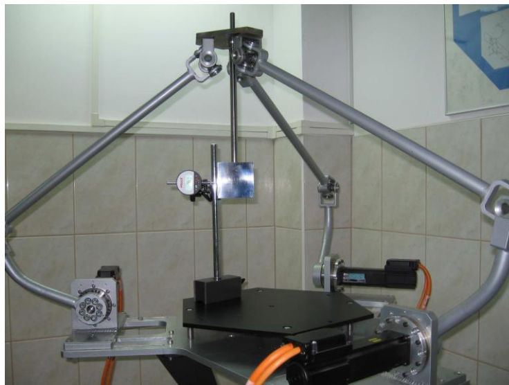
Rys. 5.2. Stanowisko manipulatora z układem pomiarowym
