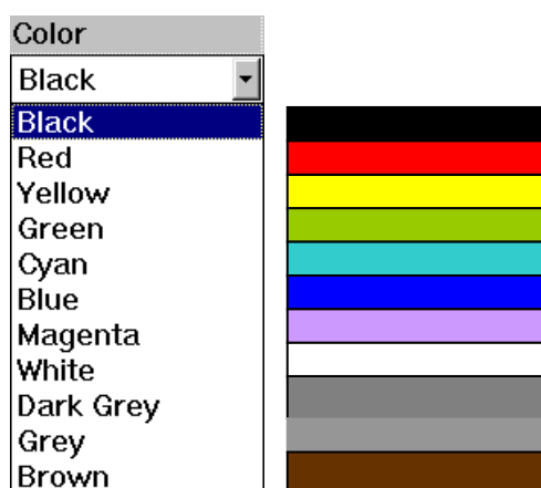
Rys. 3.2.7.7. Rozwijane okno dialogowe Color polecenia Line settings z dostępnymi kolorami wyświetlanych linii
